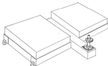
3. Прикрутите механизм вращения (A) к базе при помощи М10 болтов (С).
