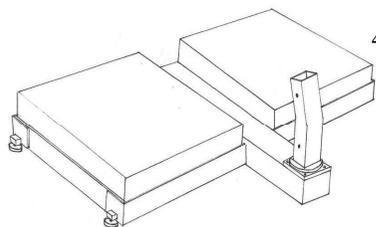
4. Оденьте базовый металлический рукав (E) на механизм вращения (A). Квадратный рукав должен зафиксироваться на четырех выступах, расположенных на круглой пластиковой пластине механизма вращения.
