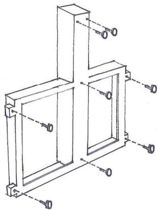
1. Прикрутите пластиковые ножки (S) снизу к базе (P).
