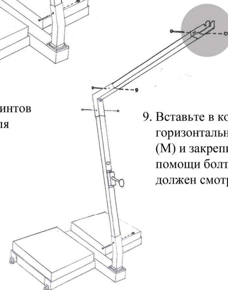
9. Вставьте в колено горизонтальную опору (M) и закрепите при помощи болта (R). Крюк должен смотреть вверх.
