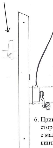
6. Прикрутите лебедку (I) с другой стороны при помощи 6-и крепежных винтов с маленькими головками. Отверстия для винтов просверлены.
